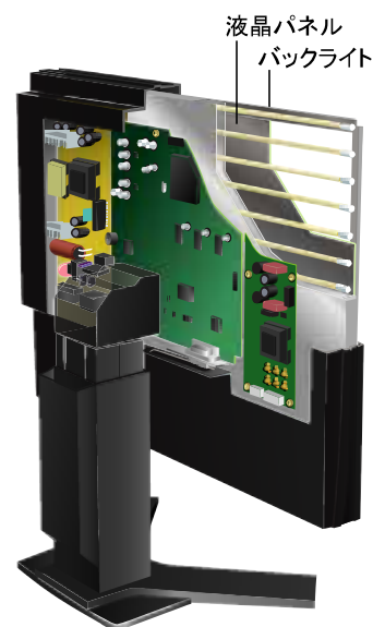
図 7 液晶モニターの構造
