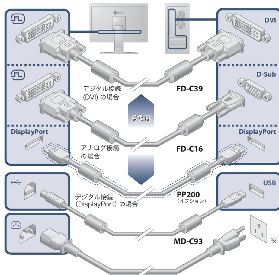
※電源コンセントが二芯の場合、付属の二芯アダプタを使用し、アースリード (緑) を必ず接地してください。
