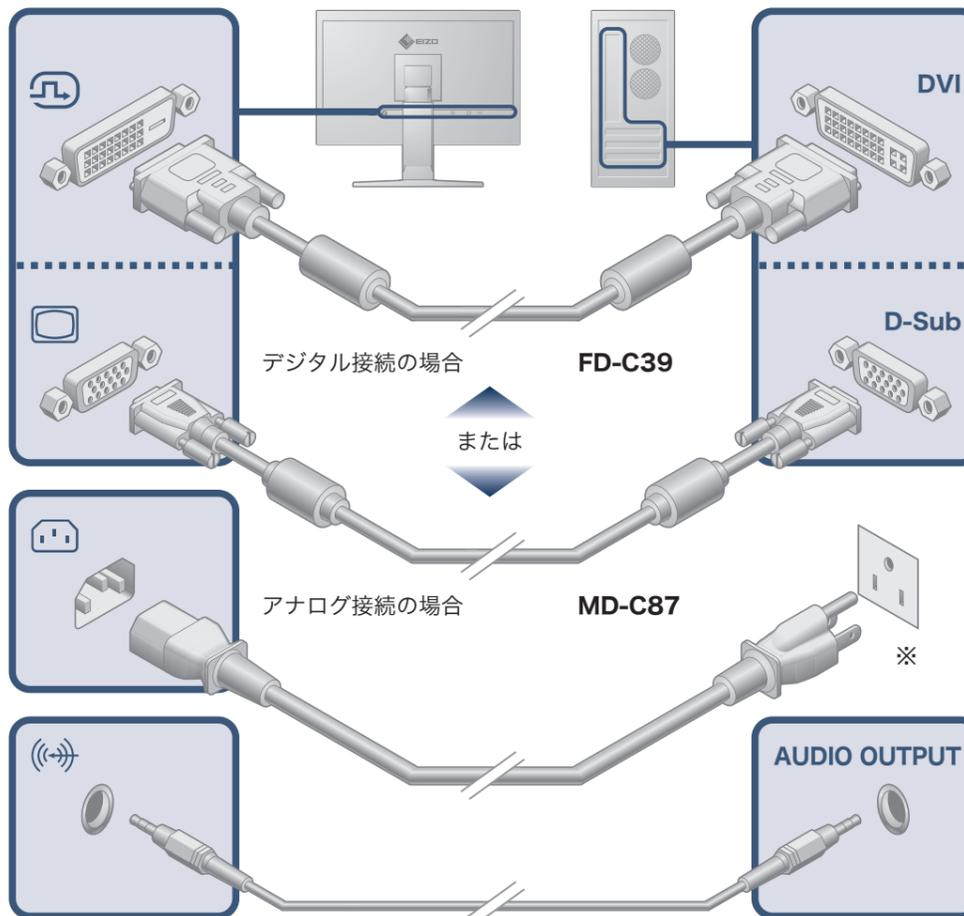
※電源コンセントが二芯の場合、付属の二芯アダプタを使用し、アースリード（緑）を必ず接地してください。
