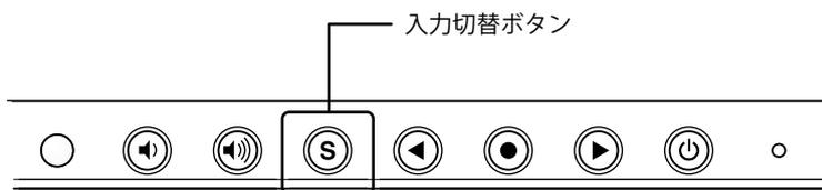
Ⓢ を押して入力信号を切り替えます。押すたびに信号が切り替わります。なお、信号を切り替えた時には、現在表示されている信号の種類（アナログまたはデジタル）が画面右上に 2 秒間表示されます。
