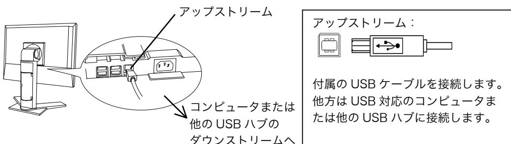
USB ケーブルの接続より自動的に USB 機能がセットアップされます。
