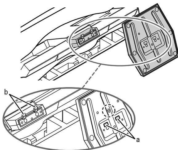
3. 付属のねじを「LOCK」の方向に回して、スタンドベースを固定します。
