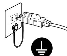
二芯アダプタのアースリード、および三芯プラグのアースが、コンセントの他の電極に接触しないようにしてください。
