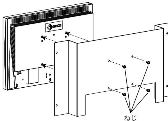
3. 取付金具をラックに取り付けます。付属のねじ（M5 × 12mm）で4箇所を固定してください。ねじは確実に締め付けてください。
