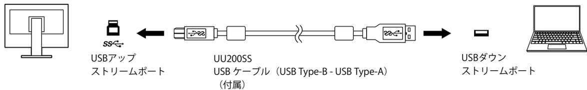
2. USB対応の周辺機器をモニターのUSBダウンストリームポート (P.9) に接続します。
