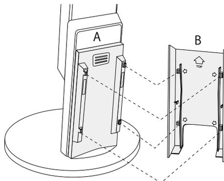
4. (A) と (B) の間にケーブルを通し、取り付け位置に合わせて (B) を (A) にはめ込みます。
