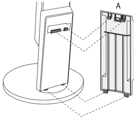
2. (A) を下にスライドし、ツメをスタンドの取り付け部分に固定します。
