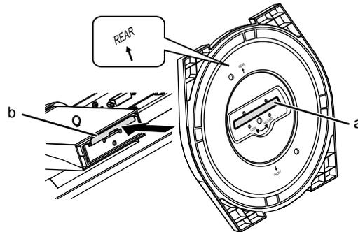
3. 付属のねじを「LOCK」の方向に回して、スタンドベースを固定します。
