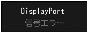
DisplayPort<br/>信号エラー</li></ul> | <p>この表示はモニターが正常に機能していても、信号が正しく入力されないときに表示されます。</p> <ul style="list-style-type: none"><li>・コンピュータによっては電源を入れても信号がすぐに出力されないため、左のような画面が表示されることがあります。</li><li>・コンピュータの電源は入っていますか。</li><li>・信号ケーブルは正しく接続されていますか。</li><li>・②で入力信号を切り替えてみてください。詳細は、設定マニュアルを参照してください。</li><li>・コンピュータの設定が、この製品で表示できる解像度、垂直走査周波数になっていますか（「5-2. 対応解像度」（P.19）参照）。</li><li>・コンピュータを再起動してみてください。</li><li>・グラフィックスボードのユーティリティなどで、適切な設定に変更してください。詳細はグラフィックスボードの取扱説明書を参照してください。</li></ul> |
