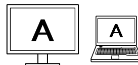
モニターとノートPCに同じ画面を表示 (×) (ミラーリング表示/複製表示)
