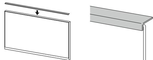
5. 液晶パネル面と剥がれ防止ガイドの間にすきまができないよう注意しながら、合わせた位置に、剥がれ防止ガイドを取り付けます。
