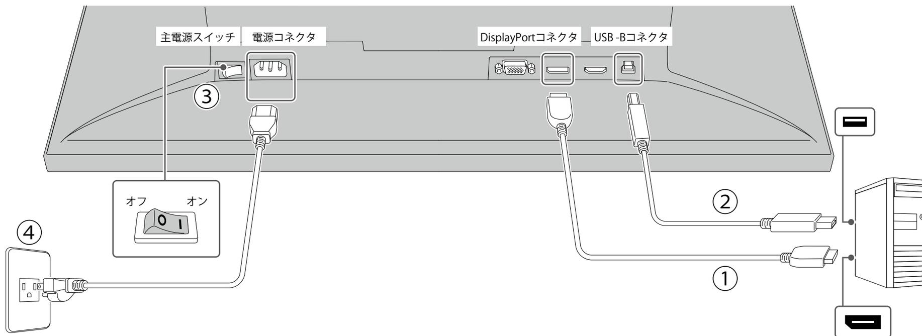
電源コンセントが二芯の場合、付属の二芯アダプタを使用し、アースリード（緑）を必ず接地してください。
