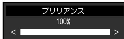
4. ◀▶で、調整 / 設定し、●を押して確定します。
