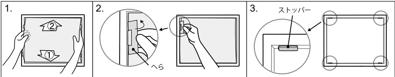
1. 保護パネルをキャビネットと液晶パネルの間に、①下部から②上部の順序で上下の溝にはめ込みます。
