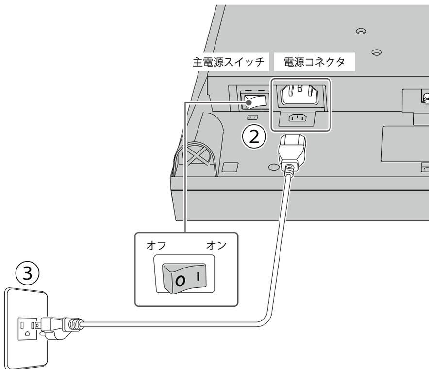
電源コンセントが二芯の場合、付属の二芯アダプタを使用し、アースリード（緑）を必ず接地してください。
