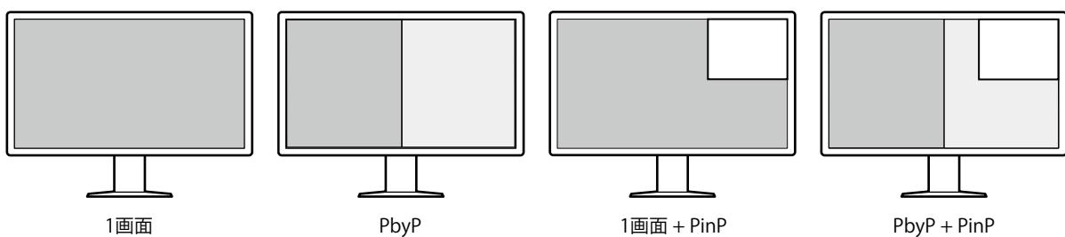
DisplayPortケーブル1本でPbyP表示が可能なOne Cable PbyP機能を搭載しています。
