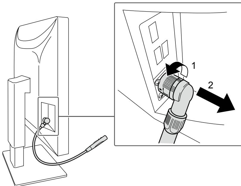
取り外す場合は、モニターとの接続部分を図の1の方向に回しながら引き抜きます。
