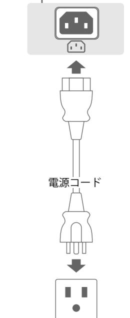
電源コンセントが二芯の場合、付属の二芯アダプタを使用し、アースリード(緑)を必ず接地してください。
