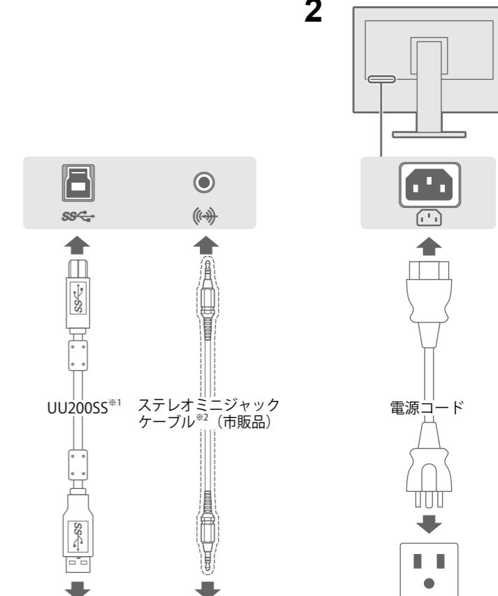
電源コンセントが二芯の場合、付属の二芯アダプタを使用し、アースリード（緑）を必ず接地してください。
