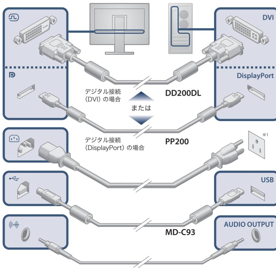
※1 電源コンセントが二芯の場合、付属の二芯アダプタを使用し、アースリード (緑) を必ず接地してください。
