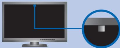
センサーが作動し、SelfCorrection を実行します。
