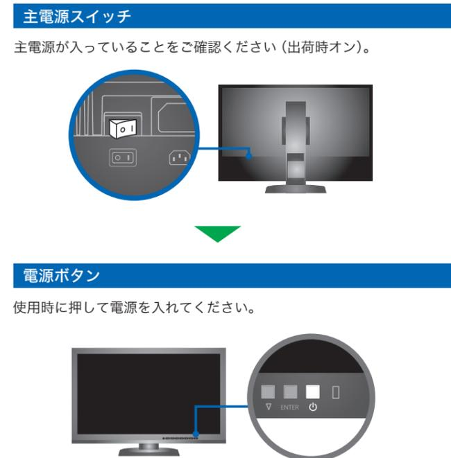
モニターの電源を入れた後に、コンピュータの電源を入れてください。ご購入後、初めて電源を入れた際には、ご使用のポートに合わせて入力信号の切り替えをおこなってください。画面下の SIGNAL を押すたびに入力信号が切り替わります。
