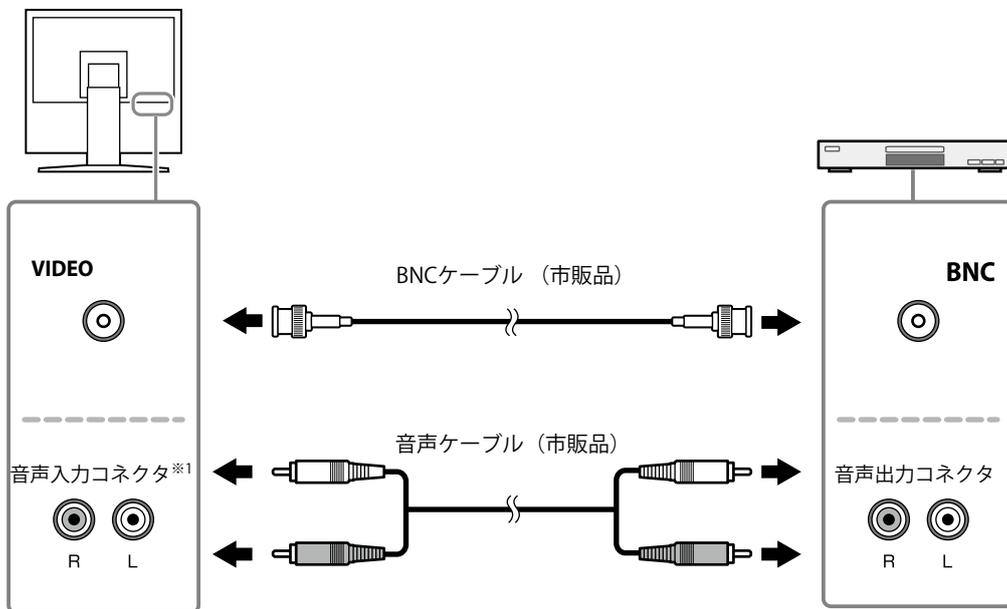
※1 この製品は、音声入力コネクタを1系統のみ搭載しています。コンピュータまたは映像機器、どちらか一方を接続してください。また、選択している入力に関係なく、常に音声は出力されます。
