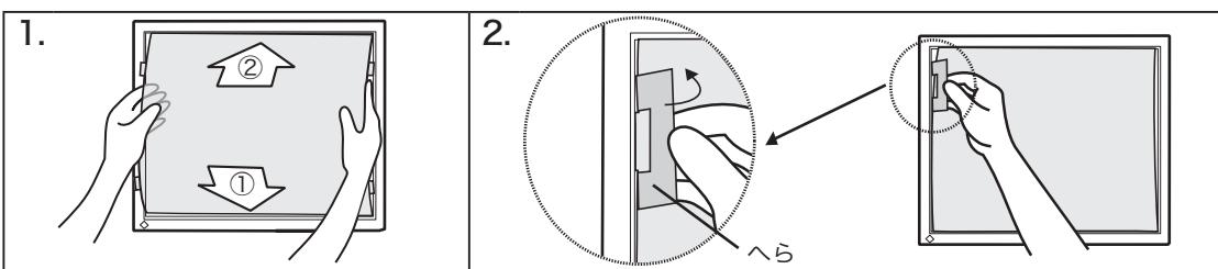
1. 保護パネルをキャビネットと液晶パネルの間に、①下部から②上部の順序で上下の溝にはめ込みます。
