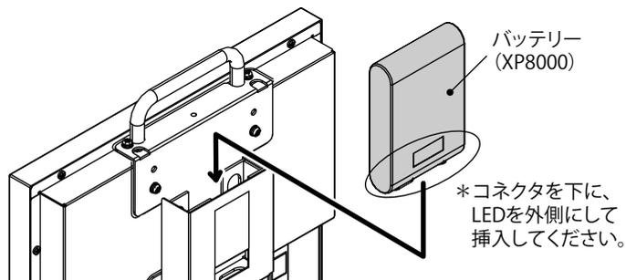
3. 手順1で取り外したバッテリー落下防止用金具を取り付けます。
