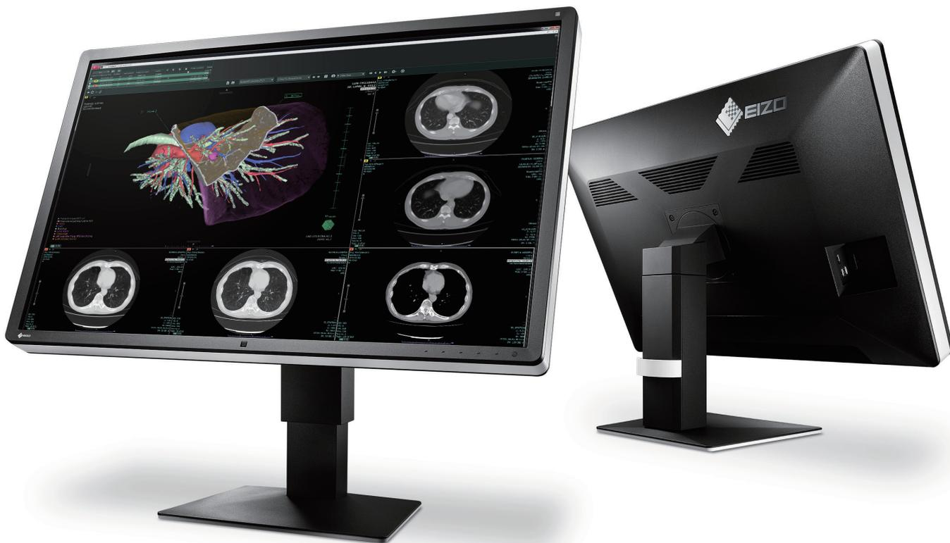
3メガピクセルモニター2台分にあたる600万画素の情報量を、対角30インチのワイド画面上に表示可能な6メガピクセル医用画像表示カラーモニターです。マルチモダリティ対応により、CRやDR、CT、MRI、超音波など、複数種類の医用画像の同時表示を実現します。さまざまな医用画像の表示に対応できる高い表示性能と使いやすさを両立したモデルです。
