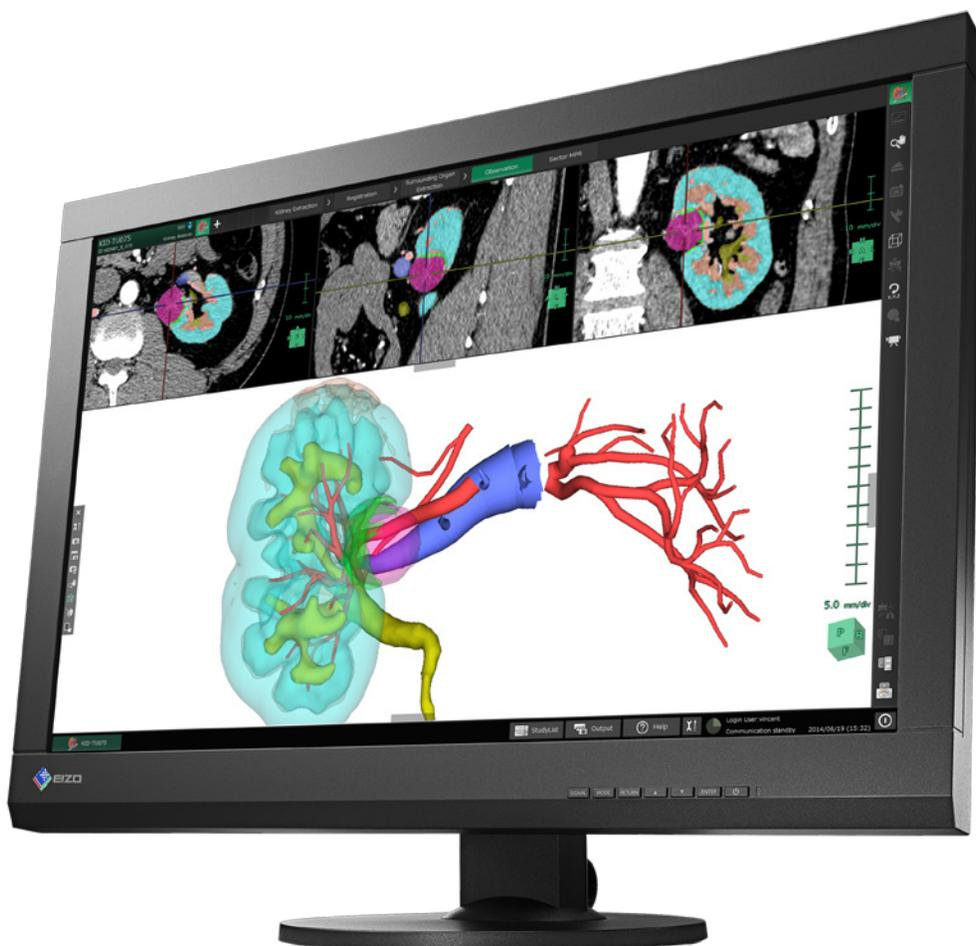
DICOM Part 14準拠のキャリブレーションに対応した信頼性とコストパフォーマンスに優れたモニターです。色彩豊かな広色域のIPSパネルを採用した、解像度1920×1200の24.1型ワイド画面は、スクロールの手間が省け作業効率が向上します。
