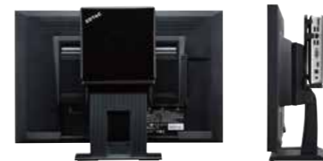
ZOTAC 社製小型 PC 取付けイメージ
