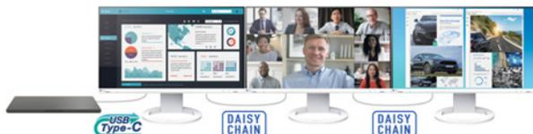
机上に紙の図面を広げて作業することがよくあるため、新オフィスではドッキングステーションやケーブル類などのアクセサリを減らし、机上がすっきりさせることを目指しました。デュアルモニター用に選定したEV2490は、USB Type-Cによるモニター同士のデージーチェーン接続に対応しています。
