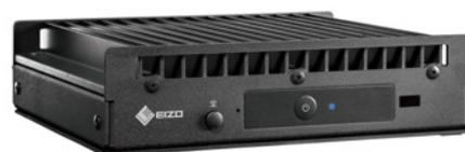
IP信号化されたMRI映像をLANケーブル・ハブを介して受取り、HDMI信号にデコードしてモニターに一覧表示
