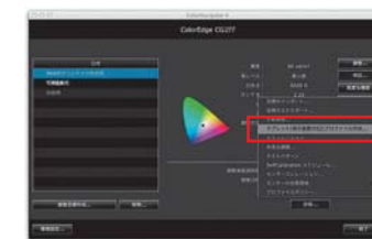
ColorNavigator 6の「タブレット/表示装置のICCプロファイル作成」から実施
