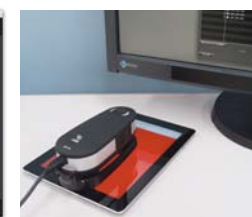
デバイスの表示状態を測定してプロファイルを作成
