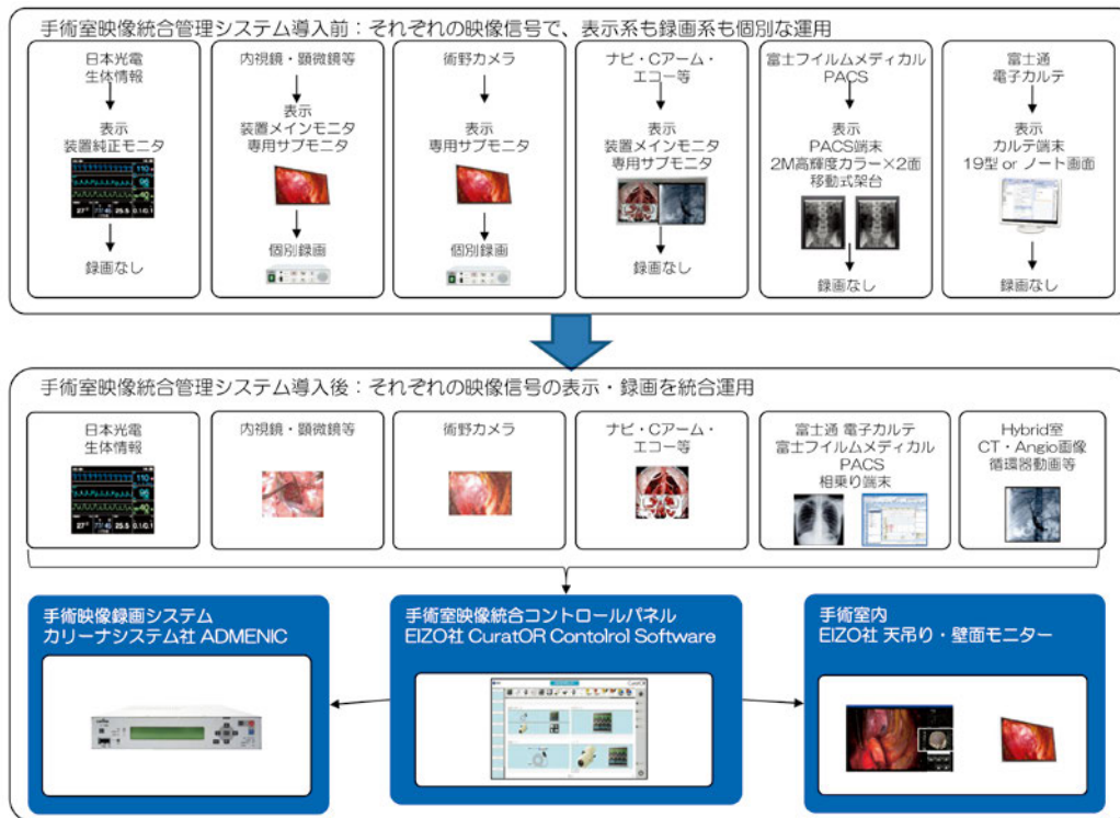
図3 手術室映像統合管理システム導入前後の運用の比較 手術室映像統合管理システム導入前は、手術中に使用する映像は各装置、端末毎に独立して個別に表示・録画の運用がされており、スタッフの負担も大きかった。システム導入後は、表示・録画ともに連動し、簡単にスムーズな運用となった
