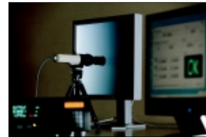
工場用の測定器で全階調を測定
