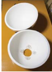
積分球の内部 照明 (LED) を配置している。
