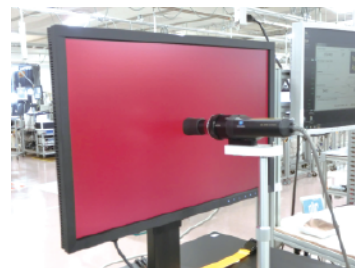
高精度センサーでの表示校正作業
