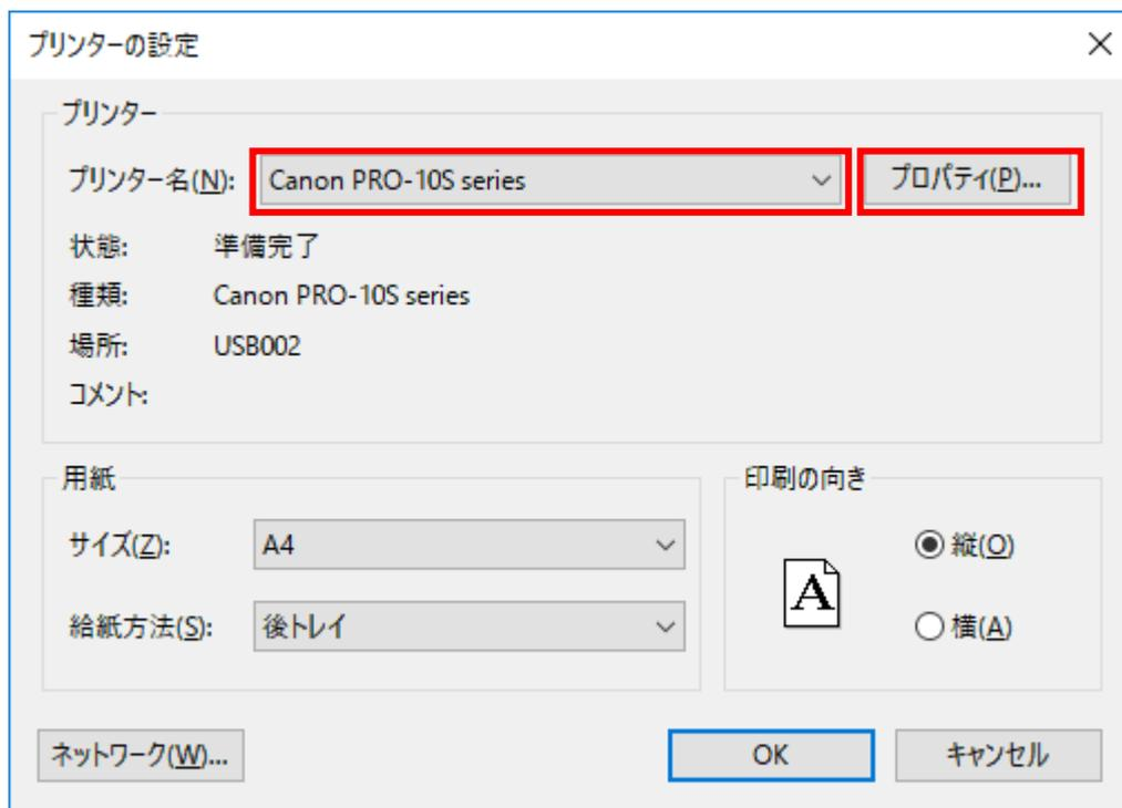
(4) プリンターのプロパティ画面で「基本設定」タブを表示し、用紙の種類に「写真用紙 光沢ゴールド」を設定、色/濃度の「マニュアル調整」にチェックを入れ「設定」ボタンをクリックする。
