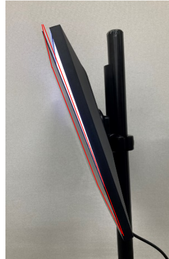
剥離がある状態
