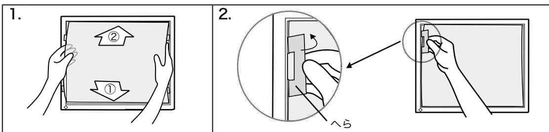
1. 保護パネルをキャビネットと液晶パネルの間に、①下部から②上部の順序で上下の溝にはめ込みます。
