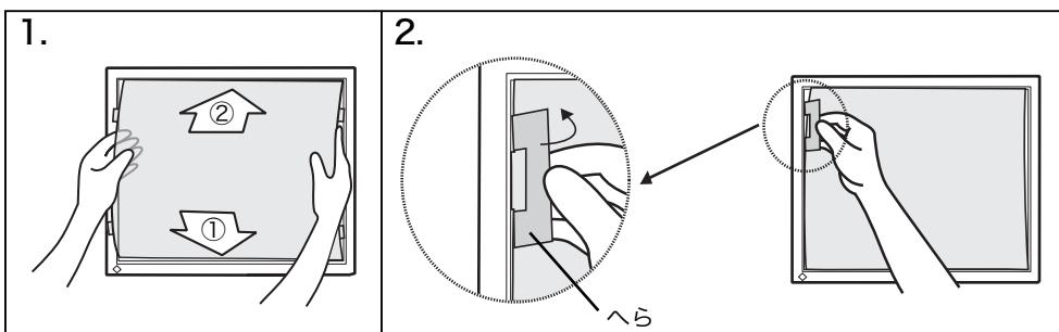
1. 保護パネルをキャビネットと液晶パネルの間に、①下部から②上部の順序で上下の溝にはめ込みます。
