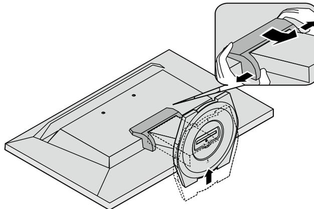
2. ドライバを使って、本体部分とスタンドを固定しているねじ3箇所を取り外します。
