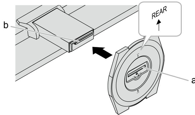
3. 付属のねじを「LOCK」の方向に回して、スタンドベースを固定します。
