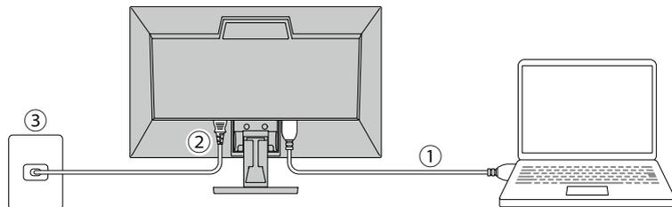
1. モニターとコンピュータを付属のDisplayPortケーブルで接続します。
