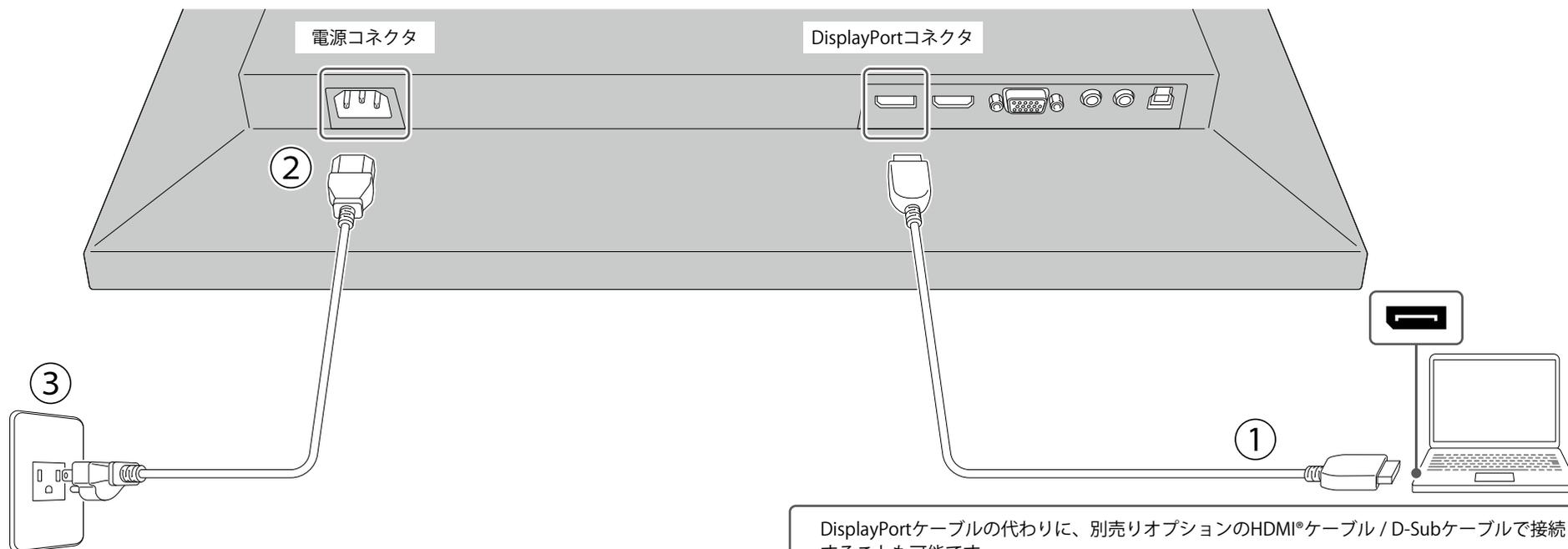
電源コンセントが二芯の場合、付属の二芯アダプタを使用し、アースリード（緑）を必ず接地してください。
