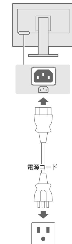
電源コンセントが二芯の場合、付属の二芯アダプタを使用し、アースリード（緑）を必ず接地してください。
