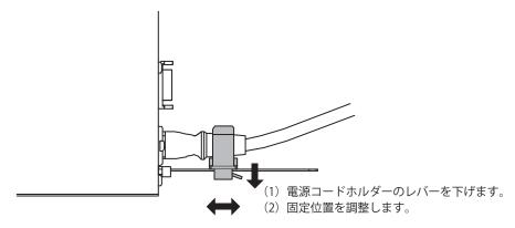
3. 電源コードが抜けないよう電源コードホルダーを固定します。
