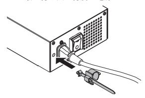
2. 次の図を参照にして、電源コードホルダーを固定する位置を調整します。
