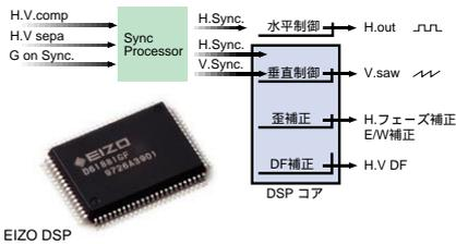
(Digital Signal Processor)を採用。DSPの演算処理によりアナログでは実現できなかった任意の波形を発生させることで歪みを補正し、適正な画像を表示します。
