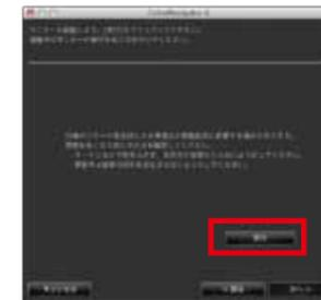
定期的な自動調整を行うためには、モニターの電源を入れてから30分待ってキャリブレーションしてください。
