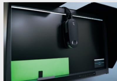
外付けセンサー(i1Pro 2)の測定結果にコレレーション
