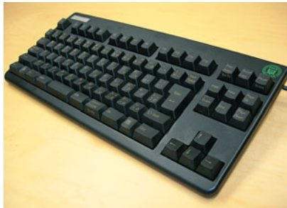
同大学に導入されているキーボード 小指は35g、薬指は40g、その他の指は45gと打つのに必要な荷重を変えてあり、静電容量の無接点方式を採用したものであるため、ミスタッチがないなど、キーボードの『一流品』である。
