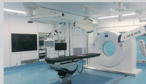
SP1-55は手術室の壁面に本体を完全に埋め込む構造で、フルHD(1920×1080)の高輝度表示が可能な55型モニターを内蔵しています。
